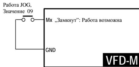
Работа в режиме JOG после состояния STOP привода. См.Pr.15, Pr.16.
