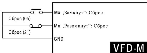
Внешняя функция RESET имеет идентичное действие, как RESET с цифровой панели управления. Когда перестала действовать причина аварии, например „EF“, „О.Н.“, „О.С.“, „О.V.“, сигнал RESET возобновляет работу привода.
