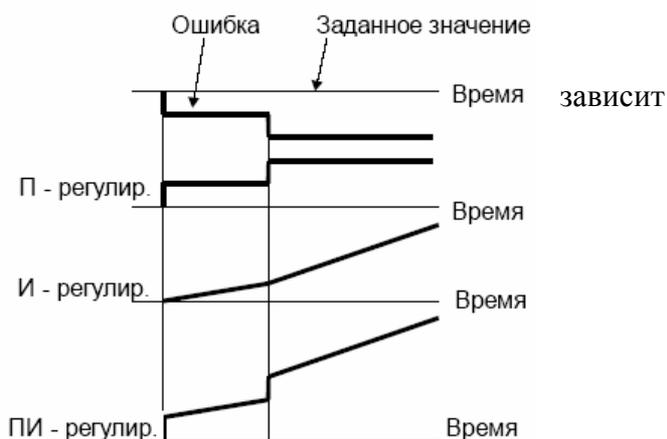
Замечание: сигнал ПИ регулятора получается как сумма пропорциональной и интегральной составляющих.
