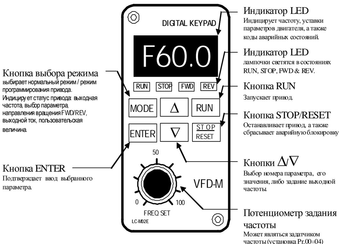
**MODE** **Режим.** Кнопка «MODE» позволяет выбрать параметр, значение которого будет выводиться на LED индикатор, а также войти в режим программирования. После подачи питания, нажатие кнопки «MODE» поочередно устанавливает следующие режимы:
