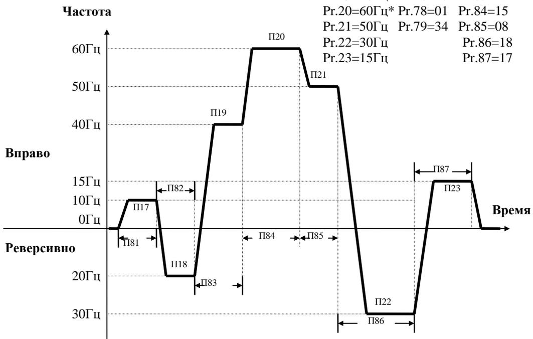
**Пример для Pr.78 = 02: Непрерывное циклическое выполнение программы**
