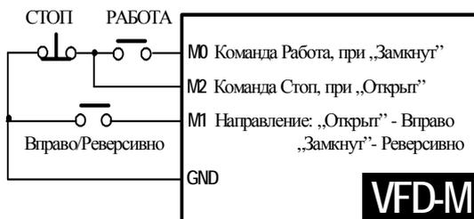
При установке Pr.38 = 02 значение Pr.39 будет проигнорировано, а кабели должны подключаться, как указано на рисунке (Режим 3).
