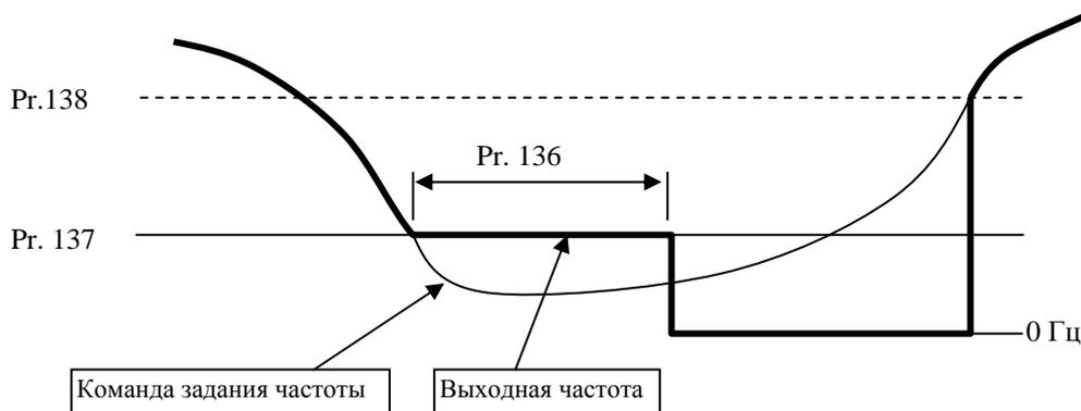
Спящий режим используется для энерго- и ресурсосбережения в системах водоснабжения, вентиляции и т.д. Суть его в том, что при малой величине задания (Pr.137) привод через время заданное в Pr.136 остановит двигатель до тех пор, пока сигнал задания не достигнет величины  $\geq$  Pr.138.
