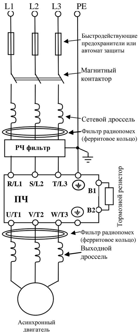
Для защиты внутренних цепей преобразователя в каждую фазу между источником питающего напряжения и преобразователем должны быть установлены быстродействующие предохранители (используемые для защиты полупроводниковых диодов), например, фирмы BUSSMAN Limitron KTK класса CC или предохранители типа gG в соответствии с требованиями стандарта EN60269 часть 1 и 2.
