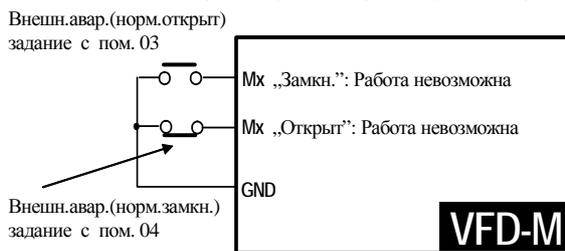
В результате получения сигнала внешней аварии наступает немедленное отключение привода (торможение с выбегом), до появления соответствующего сообщения на индикаторе. Возврат к рабочему состоянию наступит после исчезновения сигнала аварии и выполнения функции сброса (RESET).
