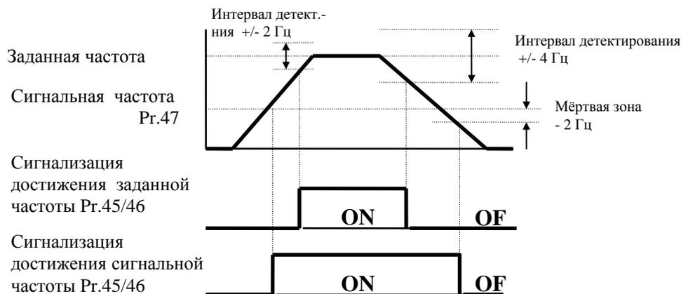
Пояснение действия зажимов многофункциональных выходов, использованных для детектирования значения частоты.
