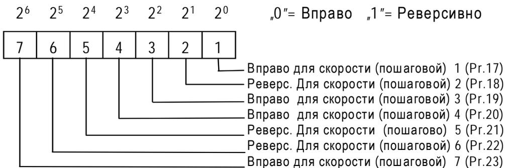
**Пример:** значение параметра = 50 заменяется на 7-битовый код следующим способом:
