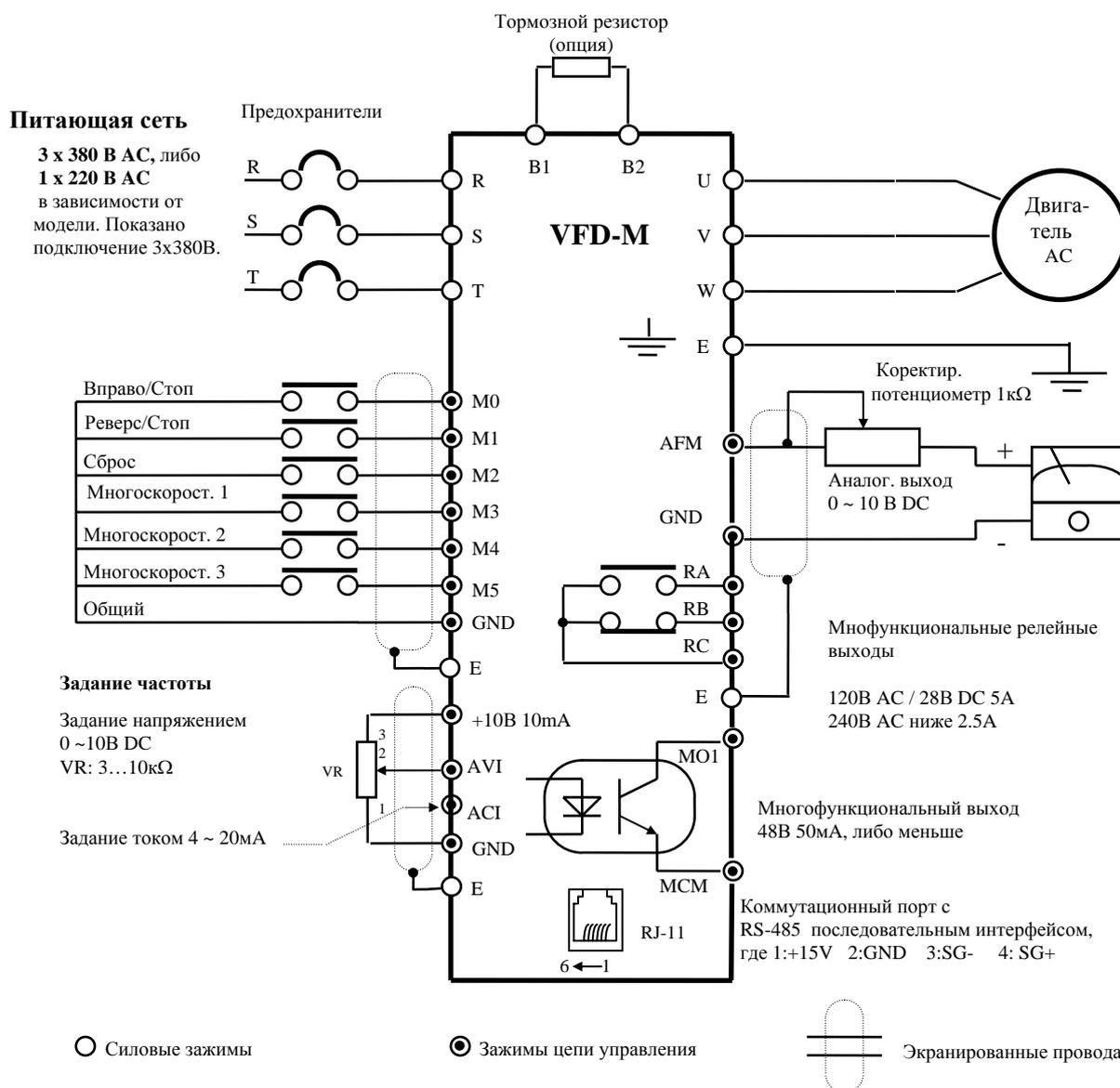
**Примечание:** Не соединяйте коммуникационный порт с модемом или телефоном. Выводы 1 и 2 принадлежат источнику питания вспомогательной клавиатуры PU06. Не используйте эти выводы, пока пользуетесь последовательным интерфейсом RS-485.
