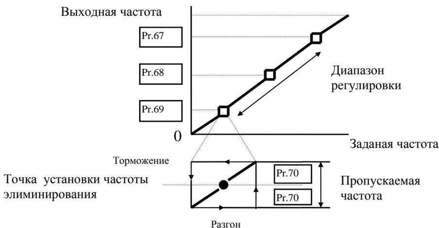
Параметр определяет ширину частотной полосы для установленных значений частоты элиминирования. Реальная ширина полосы равняется двойному значению ширины полосы Pr.70, половина ширины ниже и половина ширины выше установленного значения частоты элиминирования Pr.67, 68, 69. Чтобы выключить действие этой функции, следует установить значение параметра Pr.70 равное - 0.00.
