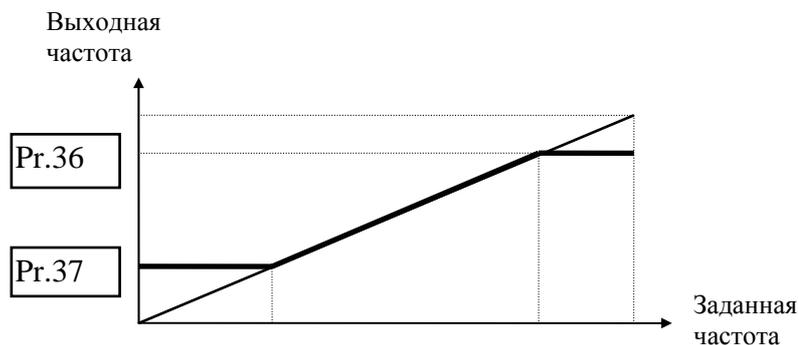
Верхнее/нижнее ограничение должно обеспечивать защиту от повреждения двигателя в случае неправильной установки максимальной и минимальной частот. Реальная выходная частота ПЧ будет находиться в пределах верхнего и нижнего ограничений, не зависимо от заданной частоты.
