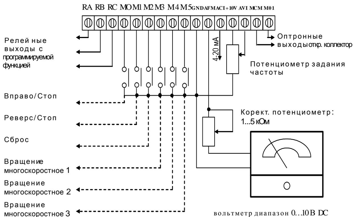
**Примечания.** 1. Для соединения управляющего устройства с управляющими терминалами используйте скрученные или экранированные провода. Экран кабеля должен соединяться только с корпусом двигателя. Рекомендуемое сечение проводов – 0,75мм<sup>2</sup> по меди. 2. Усилие затяжки винтов управляющих терминалов – 4кгс\*см.
