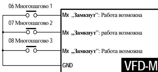
Используя три команды, можно установить работу со скоростью, заданной параметрами 17, 18, 19, 20, 21, 22, 23 (вместе 7 скоростей). Начать многоскоростную работу можно командой „RUN“, либо в авторежиме, с использованием PLC. См. Pr.78, 79, 81, 82, 83, 84, 85, 86, 87.
