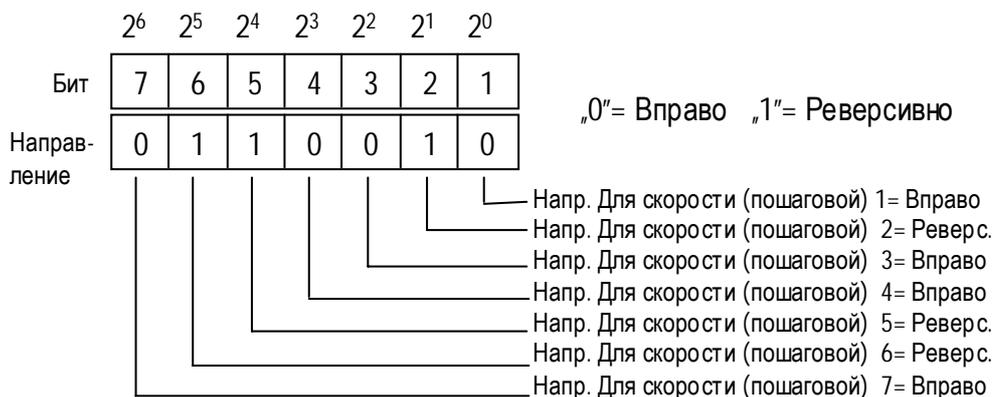
**Комментарий:** Десятичное значение = знач. бита 7 x 2<sup>6</sup> + бит 6 x 2<sup>5</sup> + бит 5 x 2<sup>4</sup> + бит 4 x 2<sup>3</sup> + бит 3 x 2<sup>2</sup> + бит 2 x 2<sup>1</sup> + бит 1 x 2<sup>0</sup> = 0 x 2<sup>6</sup> + 1 x 2<sup>5</sup> + 1 x 2<sup>4</sup> + 0 x 2<sup>3</sup> + 0 x 2<sup>2</sup> + 1 x 2<sup>1</sup> + 0 x 2<sup>0</sup> = 0 + 32 + 16 + 0 + 0 + 2 + 0 = 50
