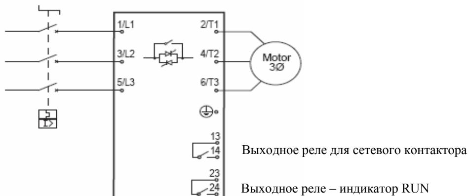
Пример 2: Подключение УПП с автоматическим выключателем и линейным контактором.
