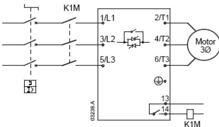
Пример 3: Подключение УПП с автоматическим выключателем, линейным контактором и отдельным тепловым реле.
