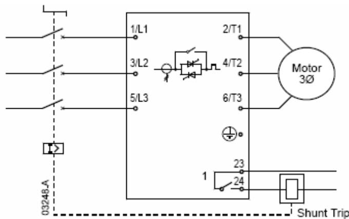
Пример 2: Подключение УПП CSX-i со схемой защиты и линейным контактором.
