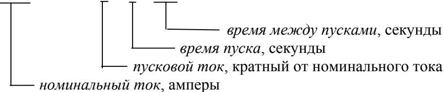
*Номинальный ток* – полный ток нагрузки устройства плавного пуска в соответствии с таблицей типономиналов.
