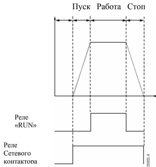
Нагрузка реле: 6 A, 30VDC – резистивная нагрузка, или 2 A, 400 VAC – нагрузка AC11
