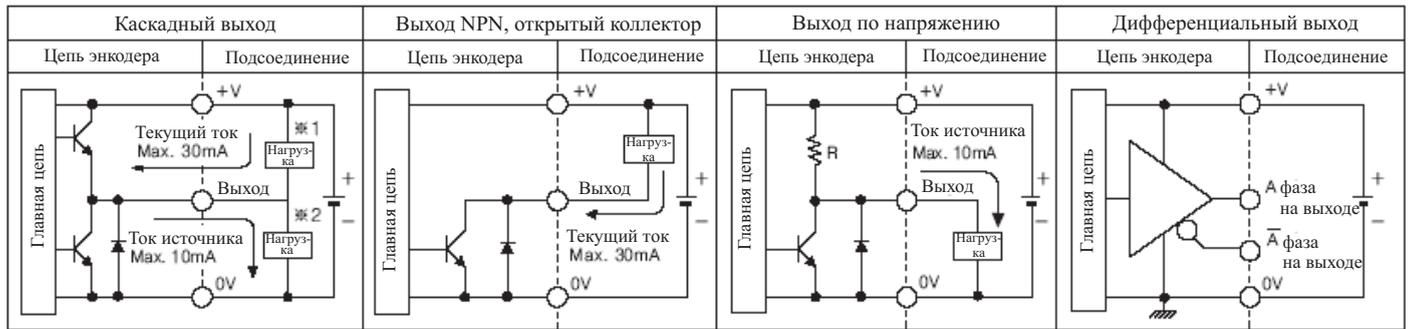
☞ Все представленные типы схем выходов имеют одинаковые фазы A, B, Z (Диффузионный выход фазы A,  $\bar{A}$ , B,  $\bar{B}$ , Z,  $\bar{Z}$ )
