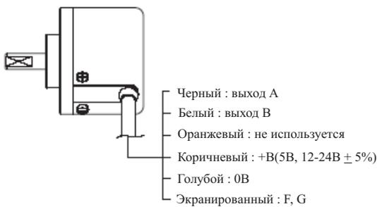
\* Неиспользуемые провода должны быть изолированы.
