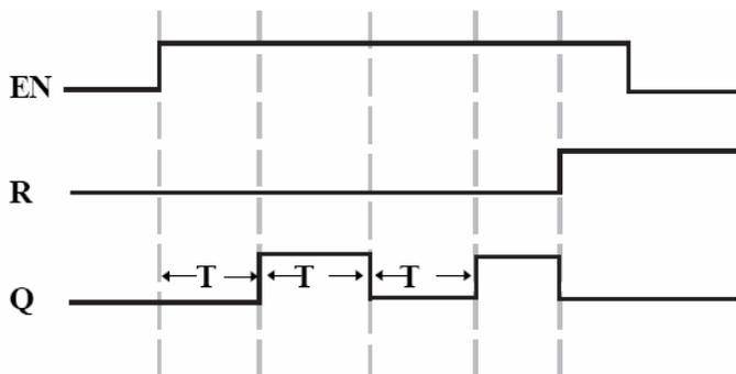
Используйте параметр T для установления времени включения/выключения. Допустимый диапазон значений T от 0,01 до 99,99. За единицу могут быть приняты часы (H), минуты (M), секунды (S). Точность уставки составляет 0,05 с. Вход EN запускает генератор. Выход Q будет переключаться всякий раз по истечению времени T. Так будет продолжаться до тех пор, пока на выходе En присутствует «1». Данная функция применима для задания последовательности автоматических включений/выключений.
