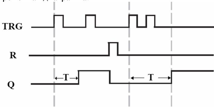
Если происходит изменение состояния триггера TRG из "0" в "1", то включается таймер. По истечение времени T, выход Q переключается в "1". Следующий сигнал на входе TRG триггера не влияет на состояние выхода Q. Только когда на входе триггера R появится сигнал "1", выход Q восстановит состояние "0".
