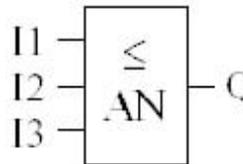
Вход 1 : могут быть выбраны I или K. Если выбран I, это означает, что эта часть блока получает сигнал с одного из входов ВоХХ. Диапазон значений I1-I6 для AF-10 и I1-I12 для AF-20. ЖК дисплей функционирует
