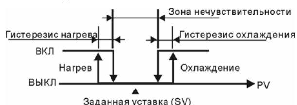
Рис.1. Двухконтурное управление при релейном регулировании (ВКЛ/ВЫКЛ)
