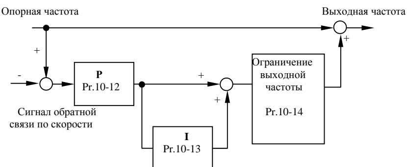
Блок-схема управления скоростью с помощью ПИД-регулятора.
