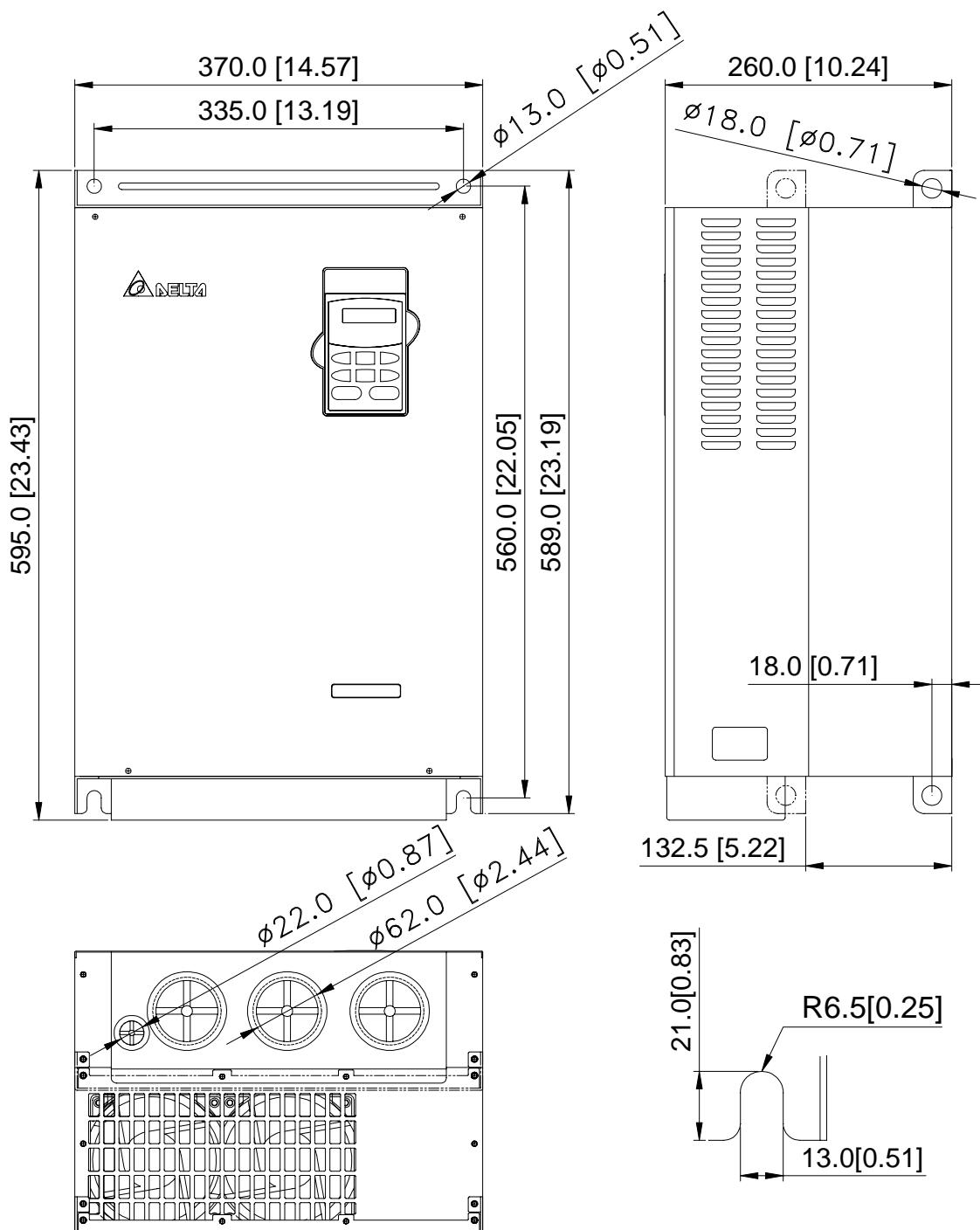
**Типоразмер F:** VFD550B43A, VFD750B43A
