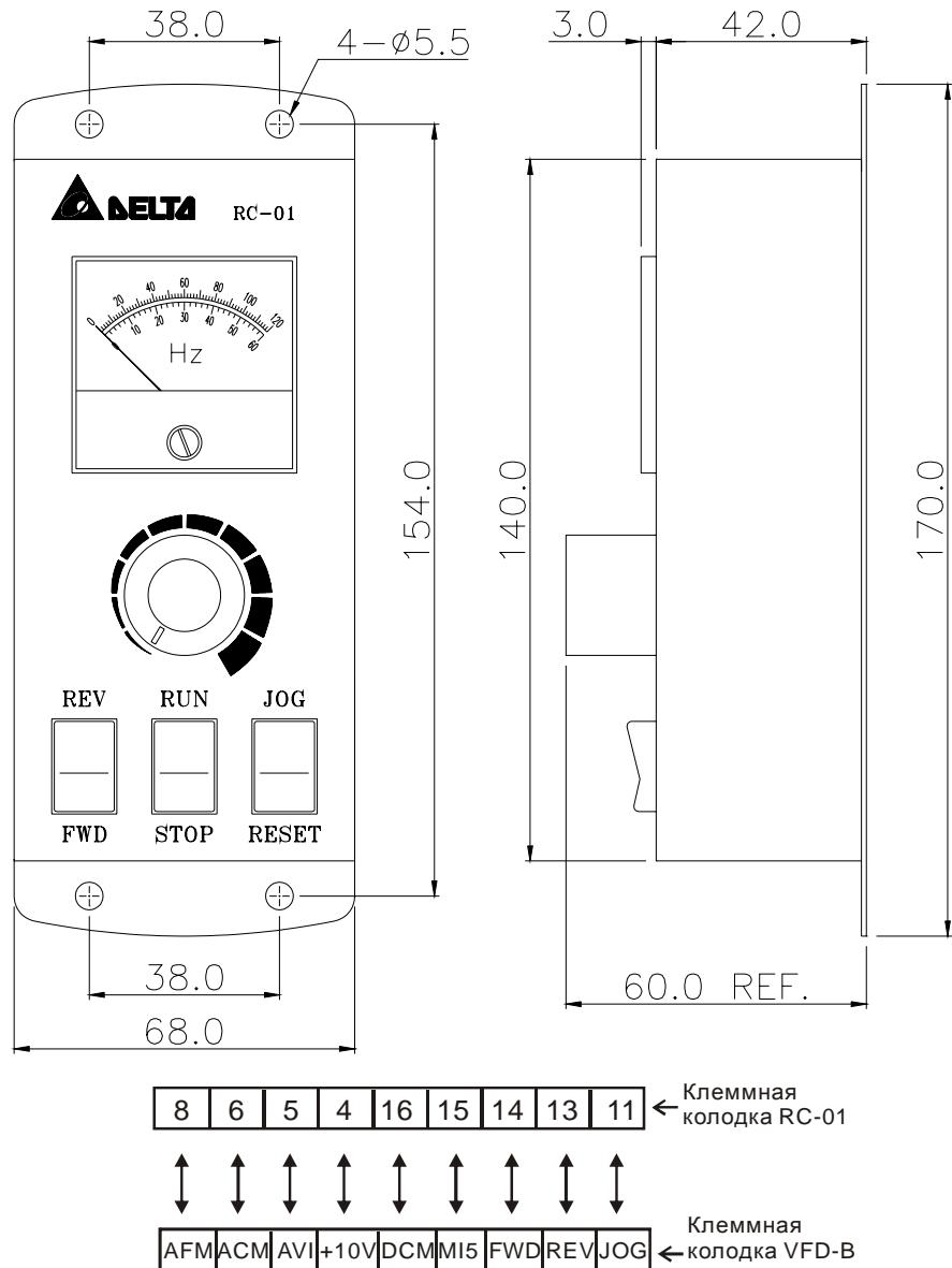
Установка параметров VFD-B для управления с пульта RC-01:
