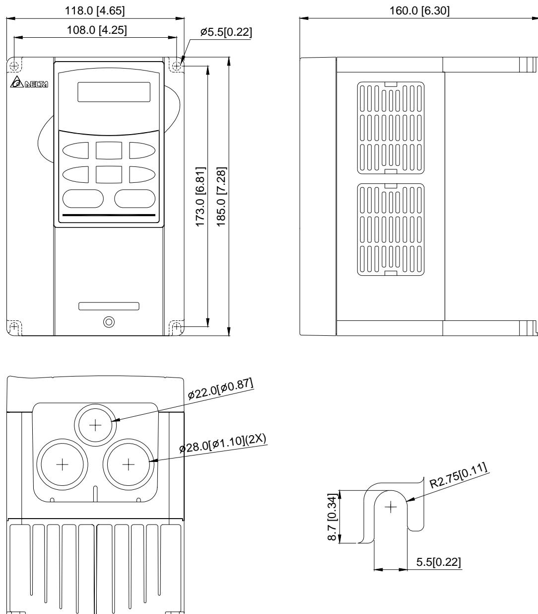
**Типоразмер А2:** VFD015B21B/23B, VFD022B23B/43B/53A
