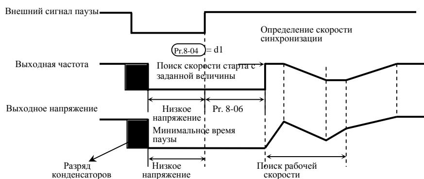
**11 и 12 :** Увеличение и соответственно уменьшение ведущей частоты. Многофункциональные входные терминалы: M1 (Pr. 4-04), M2 (Pr. 4-05), M3 (Pr. 4-06), M4 (Pr. 4-07), M5 (Pr. 4-08), M6 (4-09) программируются на выполнение функции увеличения/уменьшения частоты при каждом поступлении команды.
