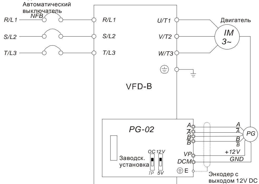
2. Схема соединений с прибором индикации скорости двигателя (RPM meter).
