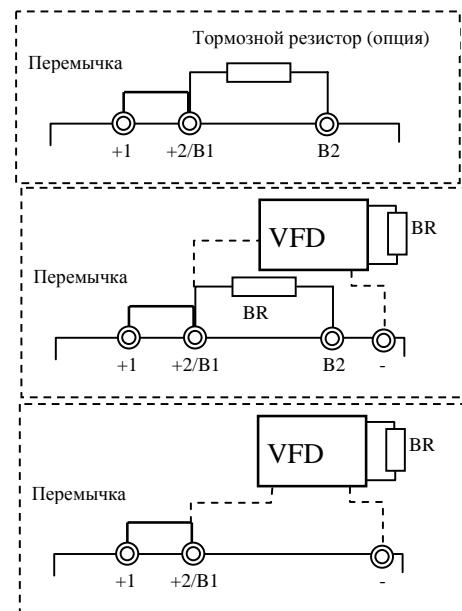
**Соединение тормозного резистора или модуля в моделях:**
