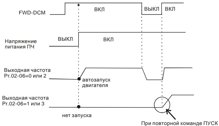
**⚠** Блокировка автостарта не гарантирует полной уверенности того, что никогда не сможет произойти самопроизвольный запуск двигателя при подаче напряжения питания на преобразователь. Двигатель может запуститься, например, при неисправности переключателя, подключенного к дискретному входу ПЧ.
