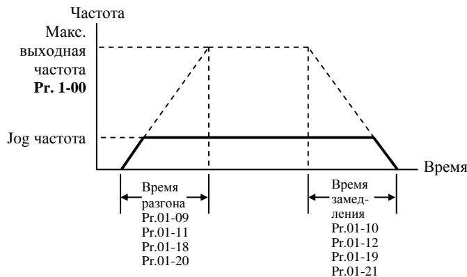
*При установке наискратчайшего времени разгона/торможения, действительное время разгона/торможения, будет зависеть от реальных механических характеристик системы, таких как момент двигателя и момент инерции.*
