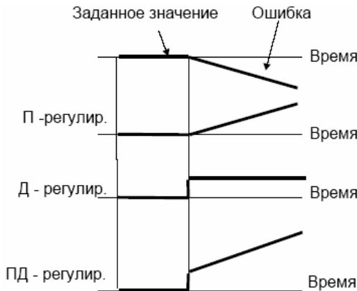
Замечание: сигнал ПД регулятора получается как сумма пропорциональной и дифференциальной составляющих.
