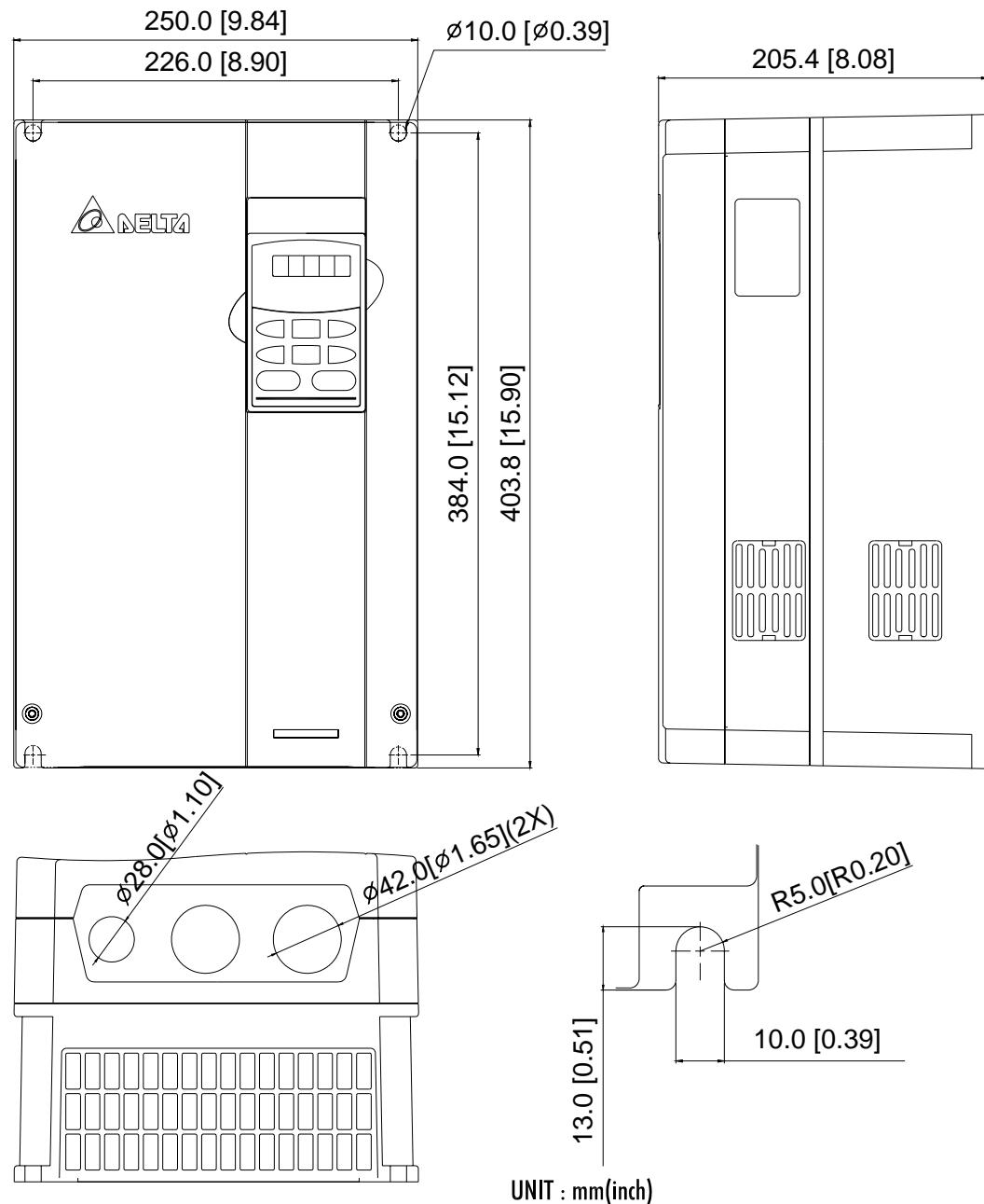
**Типоразмер Е:** VFD300B43A/53A, VFD370B43A/53A, VFD450B43A/53A
