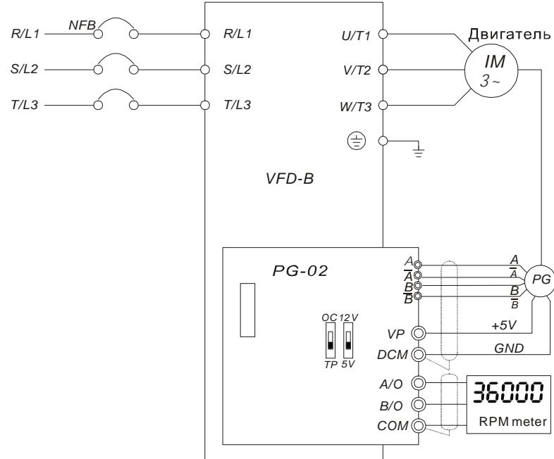
3. Схема соединений при использовании энкодера с выходом типа открытый коллектор.
