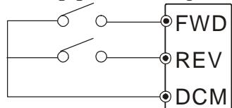
Задайте требуемую частоту вращения потенциометром, замкните контакт на терминале FWD и двигатель начнет вращаться. Разомкните контакт на терминале FWD – двигатель остановится. Частоту вращения двигателя можно изменять во время вращения двигателя. При использовании для пуска/останова кнопок без фиксации см. Pr.02-05
