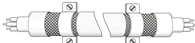
**Заземление экрана на обоих концах кабеля**
