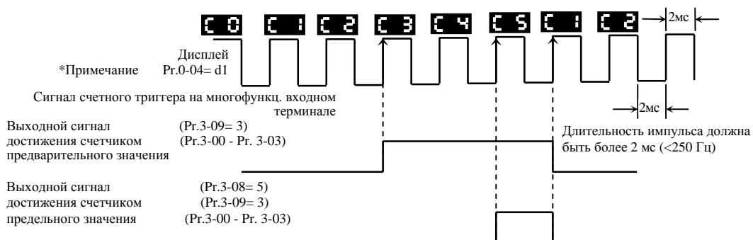
**Примечание:** Для индикации значение счетчика Pr.00-04 = 1.
