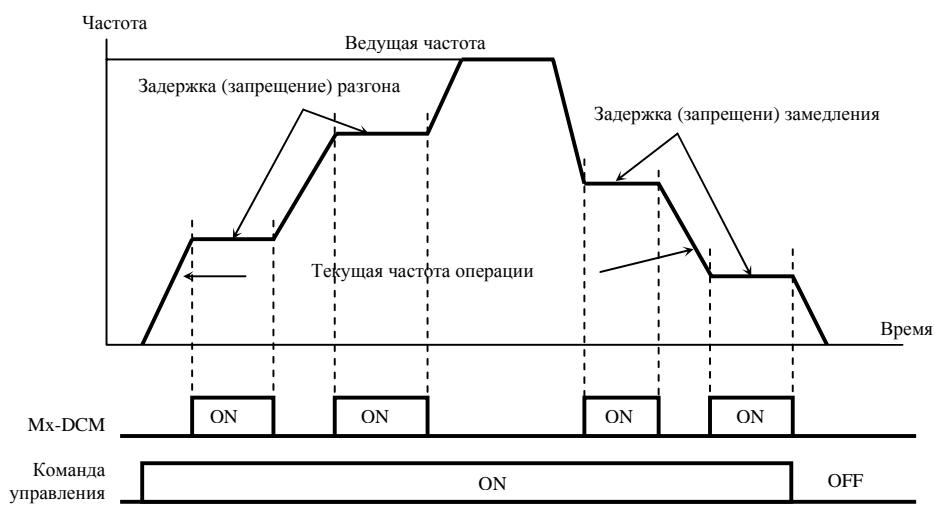
**07:** Выбор 1-ого или 2-ого времени разгона/замедления. Функция программирует входные терминалы: M1 (Pr. 4-04), M2 (Pr. 4-05), M3 (Pr. 4-06), M4 (Pr. 4-07), M5 (Pr. 4-08), M6(4-09) на функцию выбора одной из двух предустановок времени разгона/замедления (см. параметры Pr.1-09 ... Pr.1-12).
