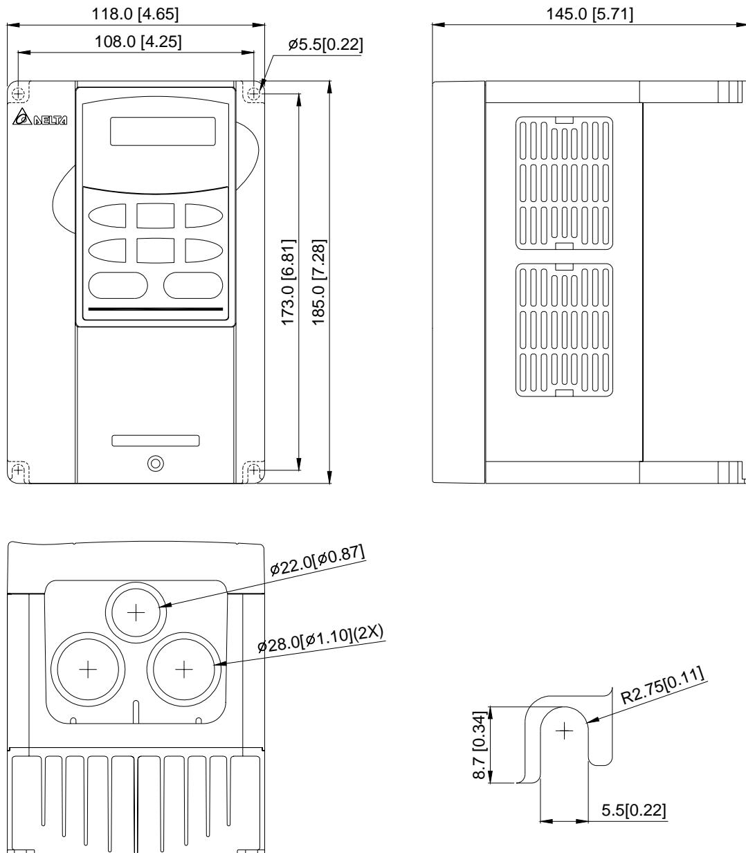
**Типоразмер А1:** VFD007B21A, VFD015B21A/23A/43A/53A
