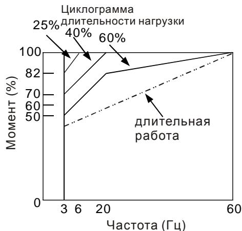
5. Для обеспечения длительных номинальных моментов при низких скоростях вращения следует использовать специальные двигатели (возможно успешное применение стандартных двигателей с номинальными частотами 750, 1000, 1500 об/мин) или двигателей повышенной мощности.
