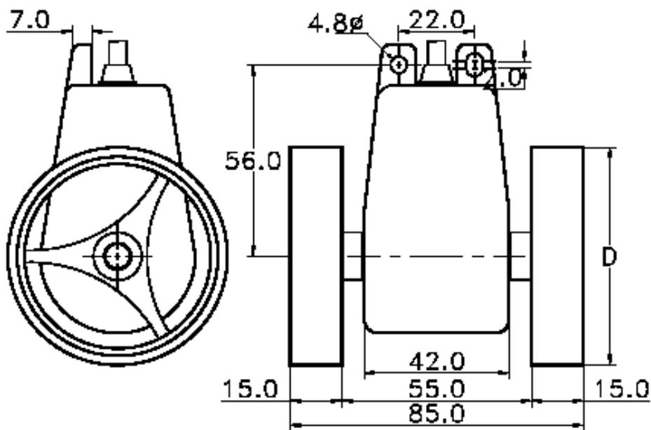
Диаметр колеса D = 63.69 мм
